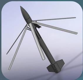
L'objectif de la FusEx Totoro est de développer un système de récupération par "parachute-parapluie". Des pétales repliés le long du corps de la fusée se déploieraient à l'apogée. Télémétrie et capteurs de déformation vont être intégrés pour mesurer les efforts subis pendant le vol.
