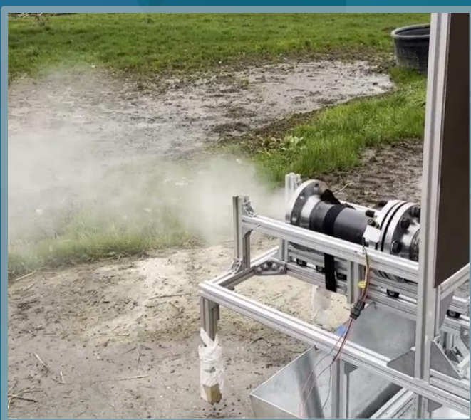
Figure 6 : Premiers tests d'injection de NAGA en basses pressions
