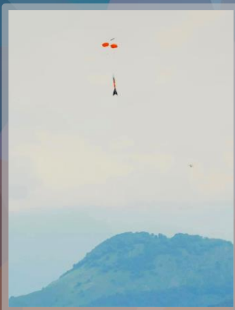
Déploiement des deux parachutes réussi pour X-FLR7
