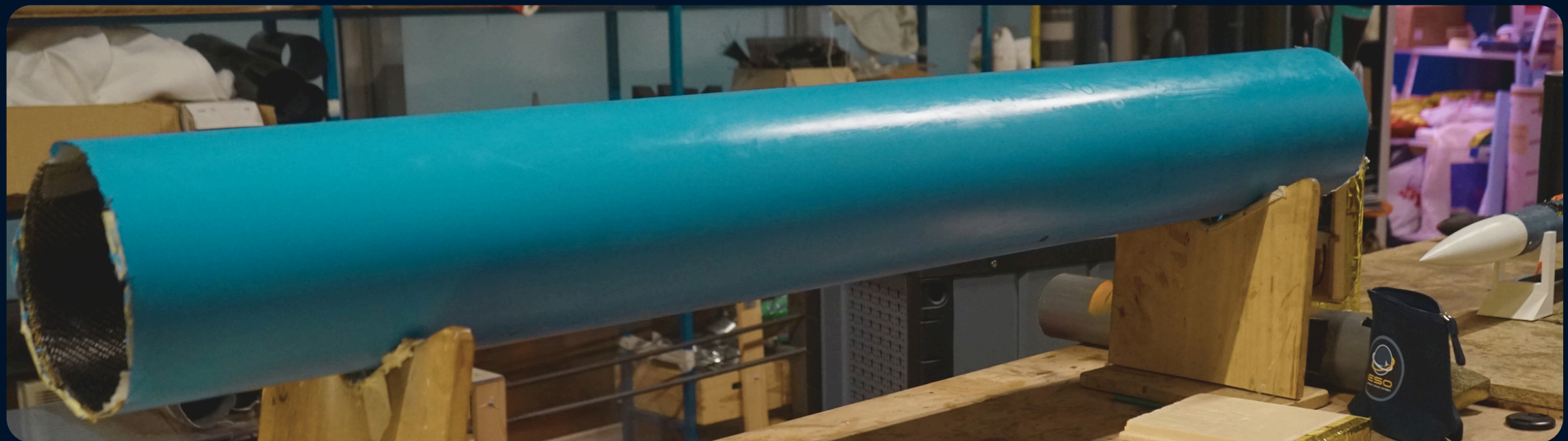
Tubes sandwich carbone fournis par EOS Technologies
